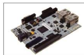
■ AM3359 工业通信引擎 (ICE) 型号: TMD5ICE3359
